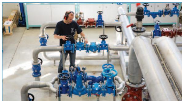
L'Office International de l'Eau met à disposition des professionnels, sur son site de Limoges, un banc d'essai pédagogique dédié à la régulation hydraulique : mise en service et réglage des appareils, modes de régulation et dysfonctionnements, maintenance et diagnostic de pannes, ...
