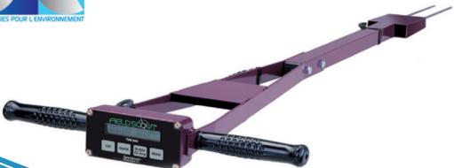
Humidimètre de sol portable pour mesure ponctuelle
