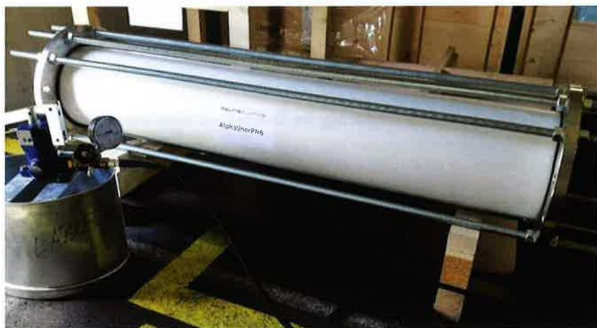
Fig. 9 – Test de vide après le test de chute de poids précédent à 0 °C et 24 heures de pression interne à 3 bar
