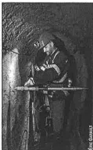
Figure 8. Mesure de la signature mécanique d'un réseau d'assainissement
