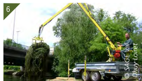
3 et 4 - Râteau hydraulique motorisé (Ratodo). 5 - Plantes chargées sur une barque ostréicole. 6 - Mini-grue pour décharger les plantes dans une benne (plucker).
