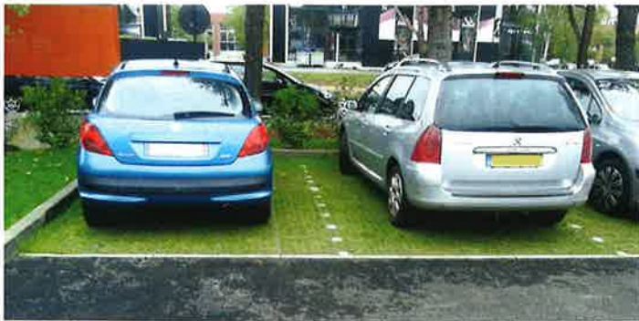
Pour renforcer l'infiltration de l'eau de pluie au plus près du point de chute, les zones de stationnement sont engazonnées.
