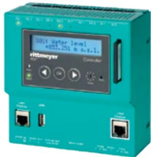
**RIPRESS premium de Rittmeyer est un système sans dérive et sans entretien qui se base sur un résonateur à cristaux de quartz. Il réalise ainsi des mesures hydrostatiques et pneumatiques ultra précises (0,01 % de la pleine échelle (soit 1 cm de précision pour 100 m de plage, 2 mm pour un marnage de 20 m) afin notamment de calculer le volume de stockage des grands lacs et des barrages.**
