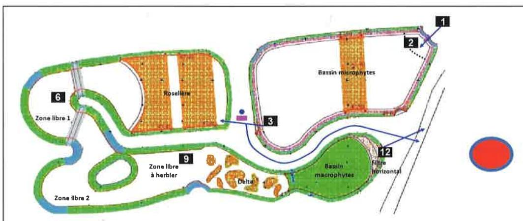
Figure 3. Schéma de la zone de rejet végétalisée (ZRV) de type bassin et localisation (en rouge) des photoréacteurs immergés dans le bassin (point rouge), l'entrée de la ZRV correspond au point 1 et la sortie au point 12
