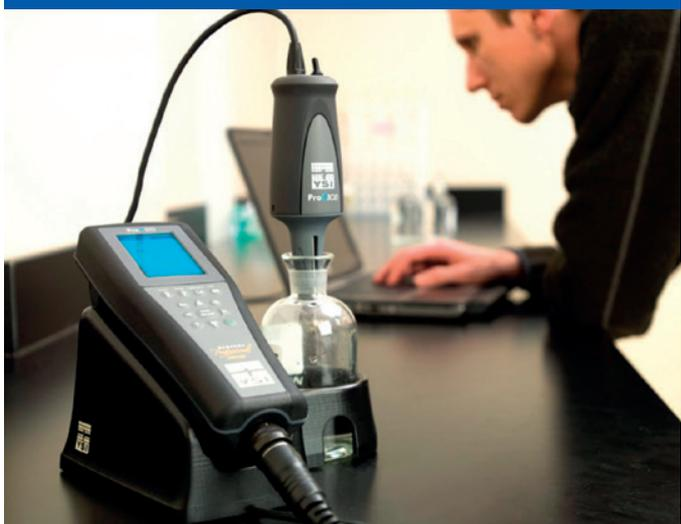
un incubateur à 20 °C pendant cinq jours. Après incubation, ils sont positionnés sur l'analyseur et la valeur finale de l'oxygène est mesurée pour calculer la DBO. Les données sont disponibles sur écran, imprimées ou converties en fichier compatible avec d'autres logiciels et le LIMS (Laboratory Information Management System). Cependant, ces procédures sont longues et astreignantes.
