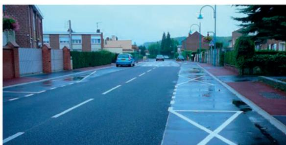
Chaussée à structure réservoir avec revêtement poreux
