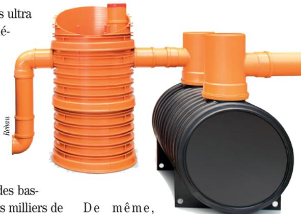
De même, Waterloc de Nicoll a été conçu pour réaliser des bassins de faible profondeur (29 cm de décaissement). Légers (13 kg seulement), empilables, ces modules facilitent la manutention, le stockage et la descente dans la fouille. Ils s'intègrent à tout type d'ouvrages: zones non circulées, chaussées à trafic léger, chaussées à trafic moyen et fort.
