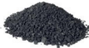
organiques. Les molécules de TCE et PCE sont bien retenues sur le charbon actif avec une efficacité plus grande pour le TCE que pour le PCE. La capacité d'adsorption du charbon actif varie en fonction de sa nature
