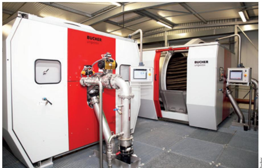
Grâce à un nouveau concept d'hydraulique, la consommation de la presse à pistons HPS 12007 de Bucher Unipektin n'est que de 20 à 50 kWh/T de MS.
