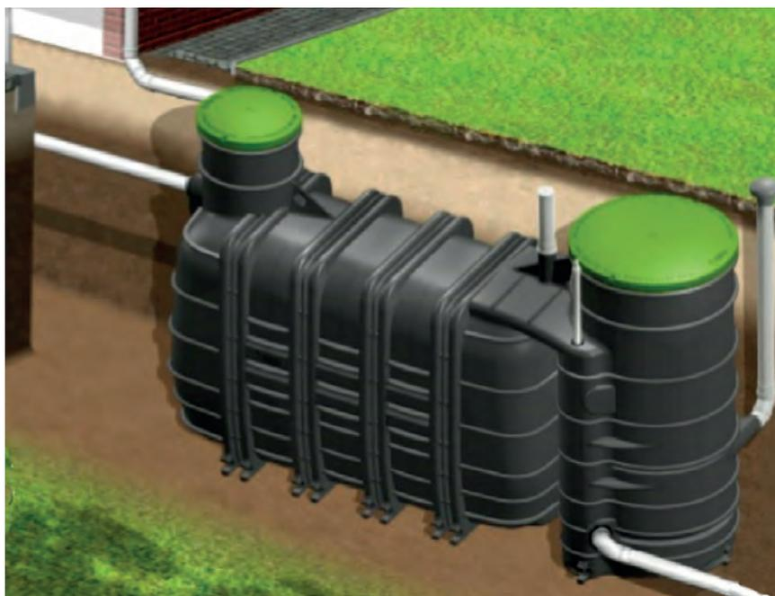
La filière Monoblock, de Biorock<sup>®</sup> (4 à 6 EH) regroupe décantation primaire et traitement secondaire en une seule et même cuve compacte. Le système fonctionne sans électricité, écartant les risques de panne et assurant des coûts de fonctionnement et d'entretien minimes.
