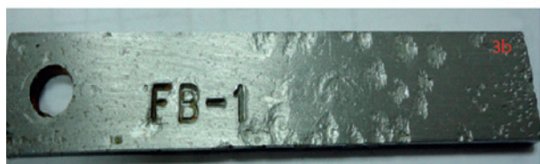
Figure 3: Détails des témoins métalliques dans des circuits de refroidissements contaminés par des bactéries sulfato-réductrices.
