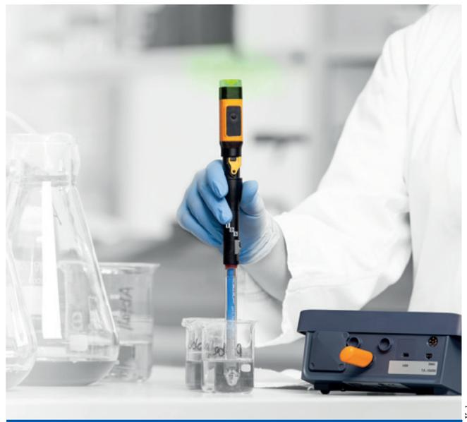
Les capteurs sans fil IDS de Xylem peuvent être utilisés avec les nouveaux boîtiers portables ou de paillasse pour les paramètres pH, redox, conductivité et oxygène.
