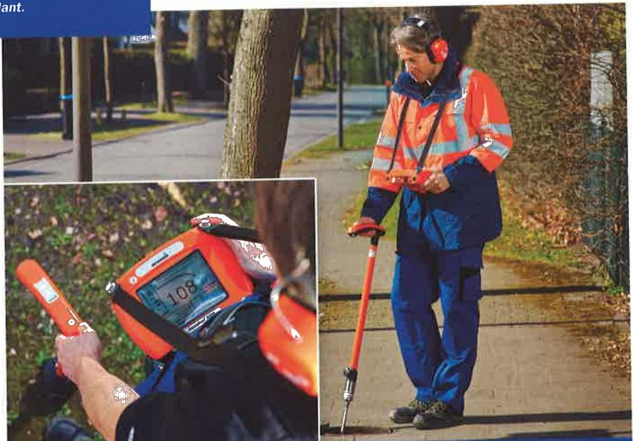
L'Aquaphon A200 se caractérise par la qualité technique de ses micros, par ses fonctions d'analyse intelligentes et par une représentation graphique ergonomique des résultats.
