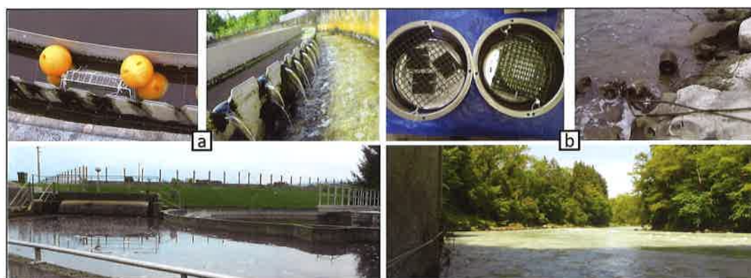
Figure 3. Dispositif d'implantation des Pocis ( polar organic compounds integrative samplers ) et des supports à biofilm dans les goulottes des clarificateurs (a) et dans la rivière (b)
