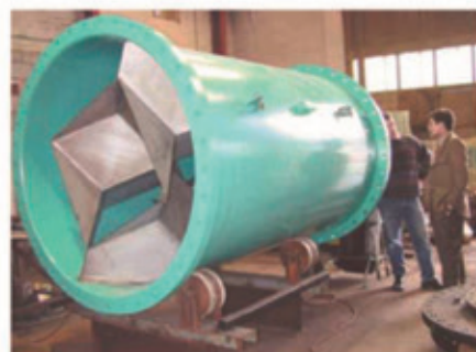
Mélangeur statique DN15 à DN3000 en tuyauteries ou canaux ouverts
