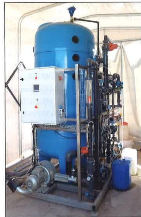
Figure 6. Pilote de filtration sur sable
