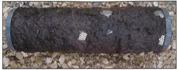
Figure 11. Colmatage du tamis (seuil de coupure à 2 500 µm) après 12 h de fonctionnement en période estivale
