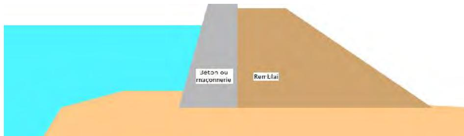
Figure 5 : Digue mixte mur de soutènement / remblai (R. Tourment)
