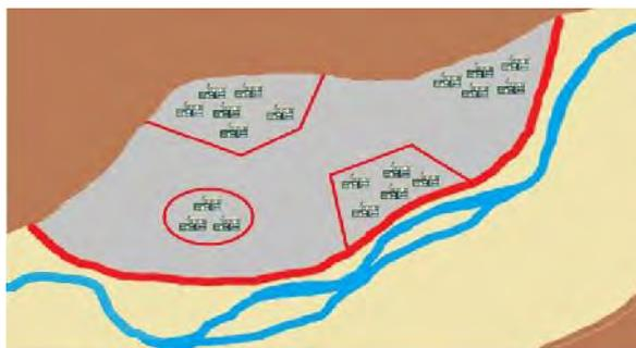
Figure 16 : Système comportant des protections rapprochées
