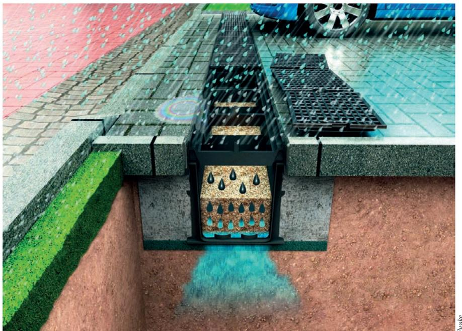
Avec ses systèmes D-Rainclean et Innolet, Funke traite la goutte d'eau là où elle tombe. Les eaux de ruissellement sont collectées à l'aide d'un caniveau ou d'un avaloir et passent à travers un substrat épuratoire qui retient métaux lourds et hydrocarbures. Les eaux peuvent ensuite être rejetées directement au milieu naturel.
