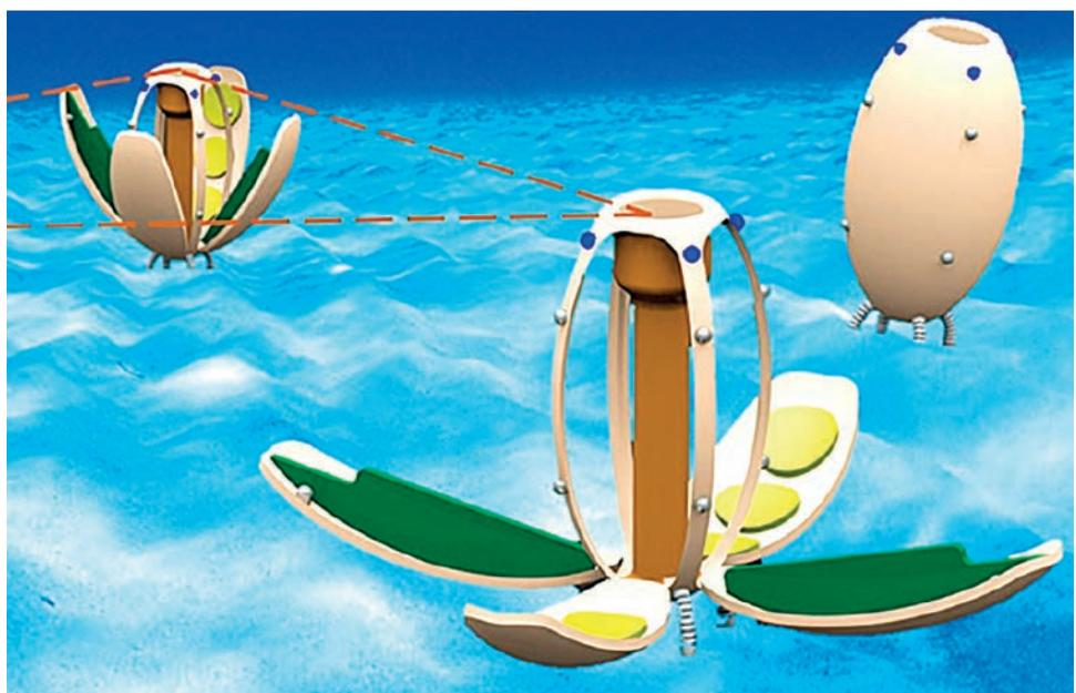
**Une fois l'écosystème mis en place, les moules artificielles ouvriront leur coquille pour déployer leurs antennes et leurs capteurs aux courants marins. Elles stockeront notamment les données collectées par les *A-fish*.**
