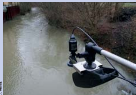
Débitmètre Raven-Eye® placé sur un pont et couplé avec une mesure de niveau radar.
