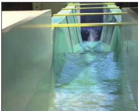
Figure 3. Vue depuis l'amont d'un canal Venturi étudié en laboratoire
