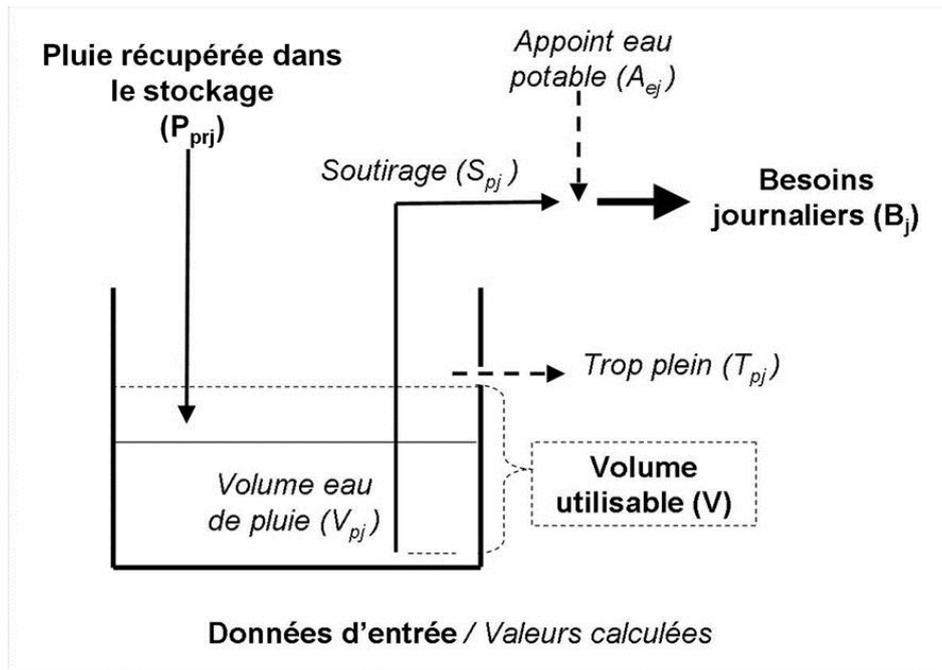
Figure 4 : Flux d'un systéme de récupération et d'utilisation d'eau de pluie
