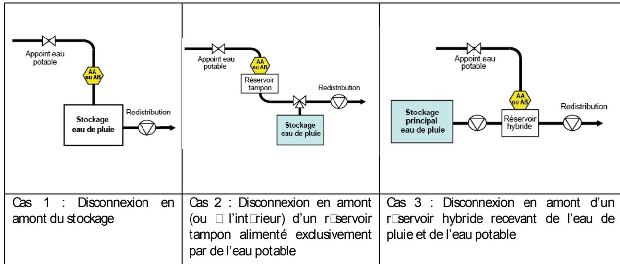
Figure 11 : Localisations possibles du dispositif de disconnexion
