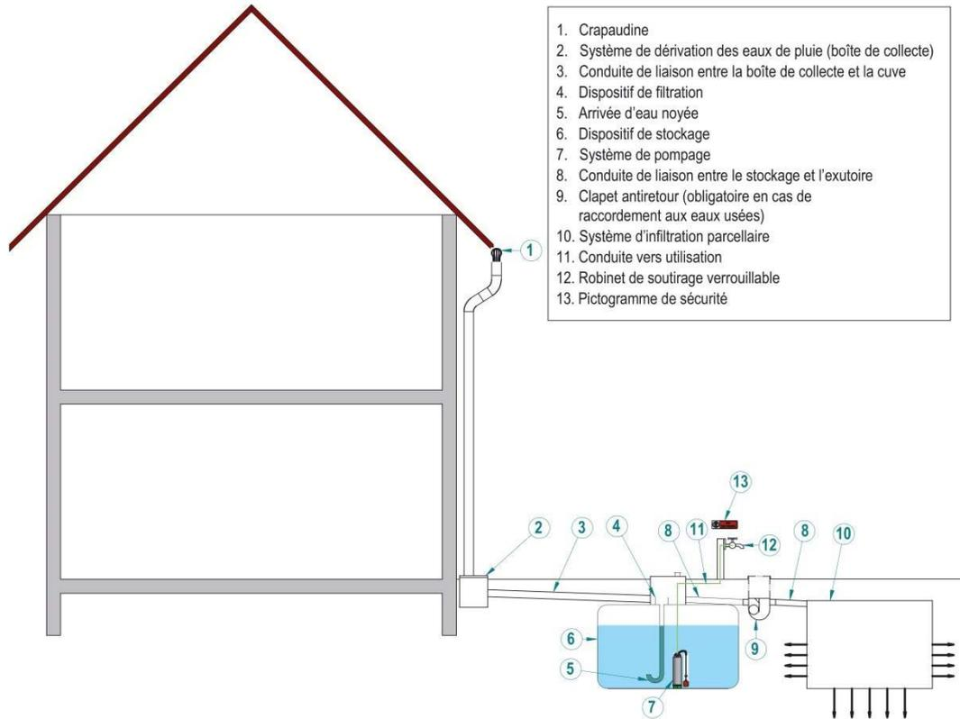
Figure 6 : Installation enterrée □ □'extérieur du bâtiment avec usage extérieur et infiltration du trop-plein
