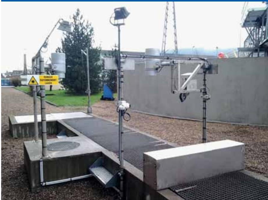
tionne automatiquement dans les environnements les plus rudes, moyennant une visite de maintenance tous les 5 à 6 ans. Capable de détecter un film d'un micromètre d'épaisseur, il envoie ses résultats par RS232, Ethernet/LAN ou liaison sans fil (GSM, radio ou Wifi). « Le ROW intéresse la pétrochimie mais aussi les ports - nous en avons récemment équipés en Italie et Estonie - pour la détection des fuites ou des rejets d'eau de cale. Il
