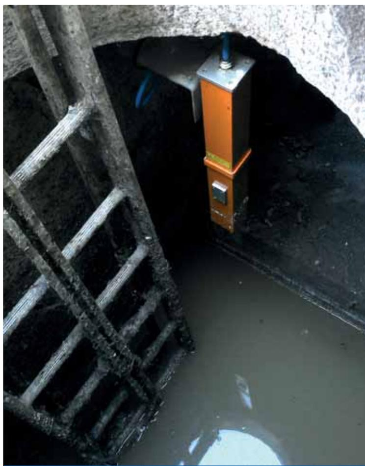
Le Row, fabriqué par LDI, exploite la fluorescence naturelle des hydrocarbures dans l'UV. Sans contact, il peut s'installer jusqu'à 10 mètres de la surface de l'eau.
