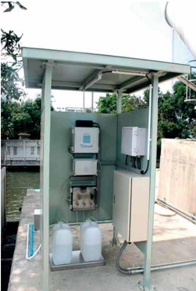
La Station d'Alerte Compacte multi-paramètres (STAC) proposée par Aqualabo (marque Secomam) est basée sur un principe d'absorption UV multi-longueurs d'onde. Elle permet d'estimer de manière simultanée la matière organique (DCO, COT, DBO), les MES et de quantifier les nitrates.
