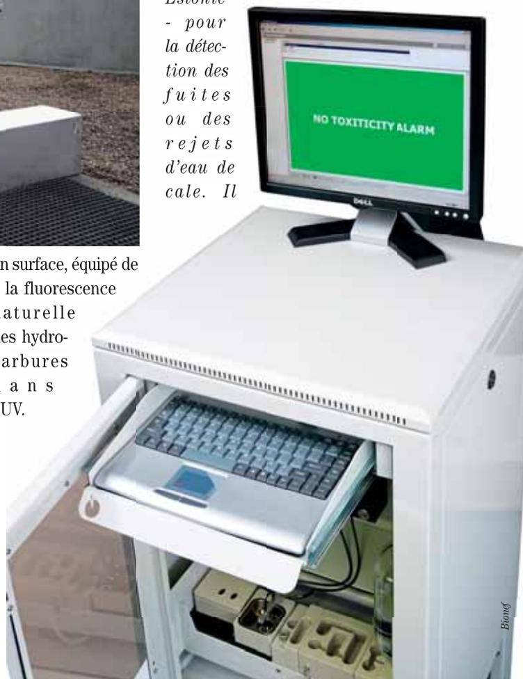
L'iTOX de Bionef utilise des bactéries luminescentes (*Vibrio fischeri*) fraîchement cultivées comme capteur biologique. La luminescence est mesurée avant et après l'exposition à l'échantillon pour calculer l'inhibition en pourcentage, conformément aux normes ISO.
