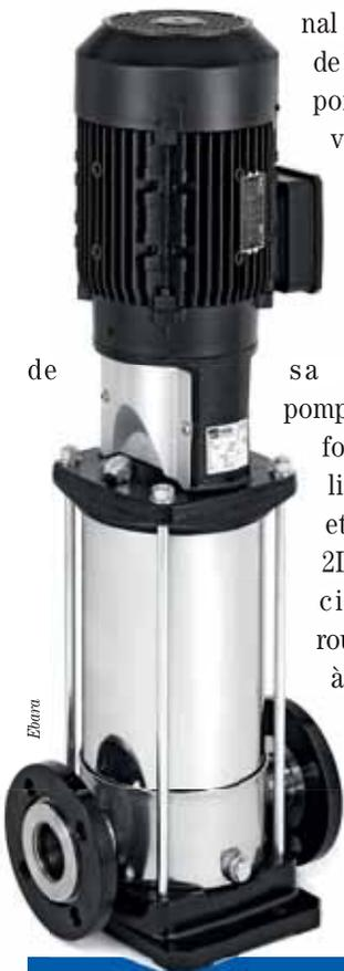
La nouvelle gamme de pompes multicellulaires verticales Ebara EVMS 1 à 20 est équipée de turbines 'Shurricane' brevetées et de moteur IE3 en standard dès 0,75 kW avec ou sans variateur de fréquence, ce qui permet d'augmenter le rendement hydraulique jusqu'à près de 73 % et ainsi réduire la consommation électrique.
