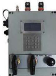
**Archimède** est un système permettant la réalisation d'essais d'étanchéité à l'eau des regards de visites, chambres et boîtes de branchement selon la méthode W de la norme NF EN1610. D'un concept totalement nouveau (brevet déposé), le système Archimède facilite la réalisation des essais auparavant compliqués à mettre en œuvre en s'affranchissant de la pose d'un obturateur et de l'ajout d'eau.
