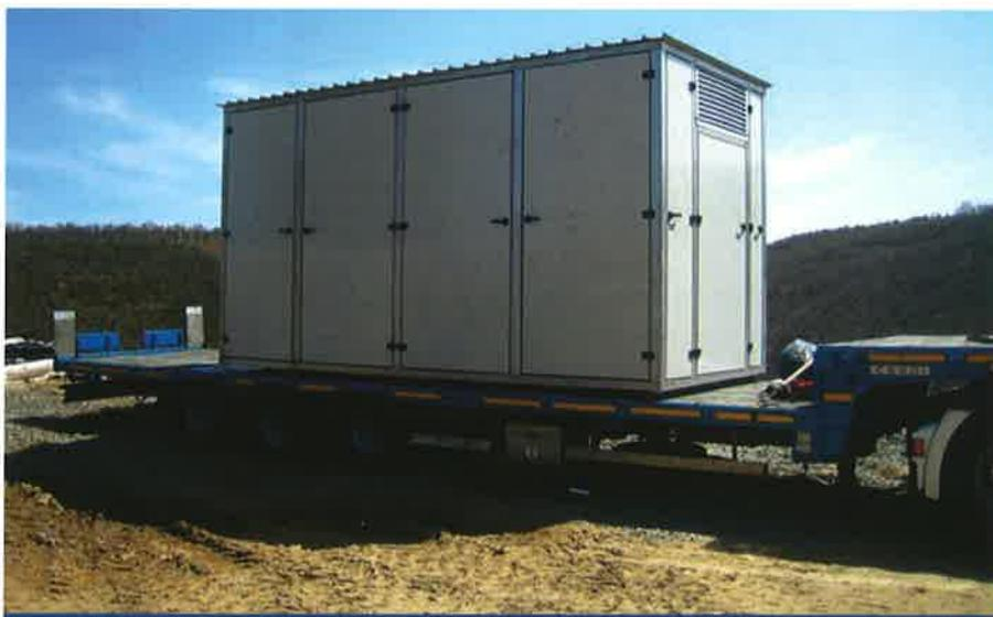
Vue d'une unité mobile de traitement en conteneur traitant 12 m<sup>3</sup>/J de lixiviat et fonctionnant à l'eau chaude issue de la cogénération des moteurs biogaz d'une décharge d'ordures ménagères. Réalisation Vivlo.
