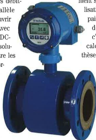
Le capteur Flomid de Teclfluid, doté du nouveau convertisseur MX4, intègre un autodiagnostic complet : courant des bobines, différence de tension des électrodes du capteur, conductivité du liquide, détection de défaut de l'électronique.
