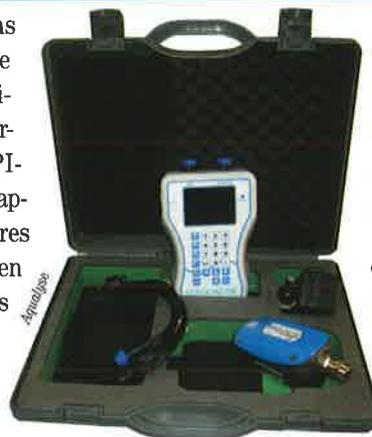
d'eau brute et au sein des systèmes d'irrigation. De petite taille, le boîtier compact du Promag 800 renferme tout: électronique, piles, enregistreur et modem GSM/GPRS, qui permet de transmettre les données. La fréquence de mesure automatique est ajustée en fonction des variations de débit: plus besoin de choisir entre précision de la mesure et durée de vie des piles.
