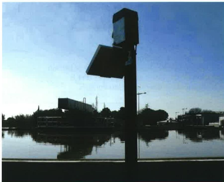
Le système intégré CairSens de Cairpol est constitué d'un capteur de type ampérométrique, d'un système de prélèvement d'air dynamique, d'un filtre breveté et d'un circuit électronique qui permet un affichage en temps réel de la concentration mesurée ainsi qu'une sauvegarde interne des données. La fiabilité de la mesure repose sur l'association du filtre spécifique qui limite les effets de la variation de l'humidité relative sur la mesure avec l'échantillonnage dynamique.
