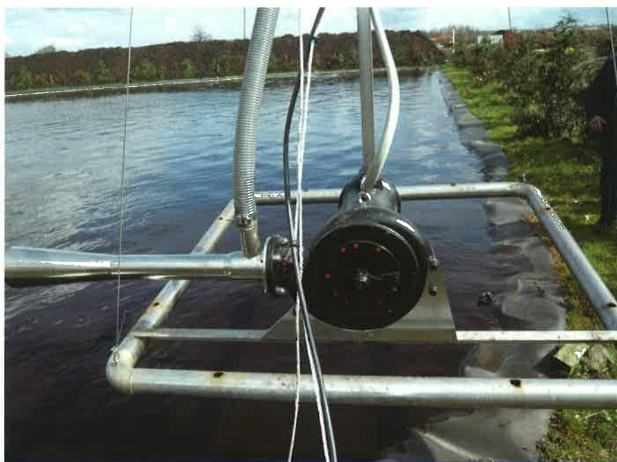
Atlantique Industrie propose le système Airjet (aération et brassage de marque Landia) dans les cas suivants: en fond de lagunes avec géomembranes (châssis spécifique immergé), sur flotteur, en traversée de parois d'un bassin (facilité d'accès) ou encore immergés sur barres de guidage orientables de 0 à 180° depuis une passerelle.
