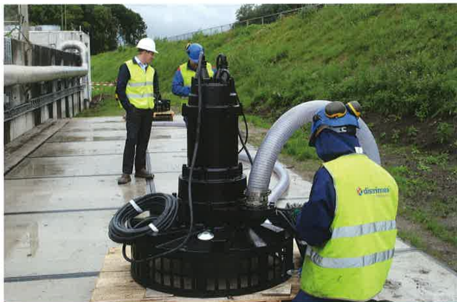
L'efficacité énergétique de l'aérateur déprimogène TRN de CE2A Tsurumi France varie de 0,9 à 1,5 kg O 2 /kWh selon les appareils et la profondeur du bassin.
