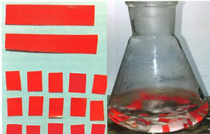
Figure 2: Essai de désencrage par l'eau de mer d'une étiquette rouge de boisson gazeuse.
