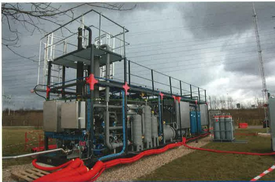
Dans le cadre du projet BioGNVAL, le système CRYO-PUR® a été installé en mars 2015 à la station d'épuration de Valenton. Le biogaz issu des boues d'épuration est ainsi transformé en deux produits : du Bio-GNL utilisé pour le transport poids lourds longue distance et du Bio-CO<sub>2</sub> avec un niveau de pureté permettant sa valorisation dans des applications industrielles.
