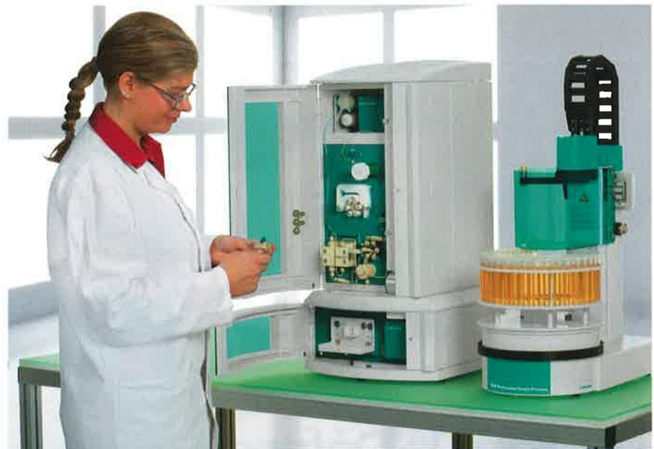
**La 930 Compact IC Flex de Metrohm est une chaîne de chromatographe ionique compacte développée pour répondre aux attentes des laboratoires prestataires d'analyses ainsi que des laboratoires de contrôle de l'industrie et du publique. L'équipement se caractérise par sa simplicité d'utilisation, sa fiabilité et sa flexibilité pour les analyses de routines.**
