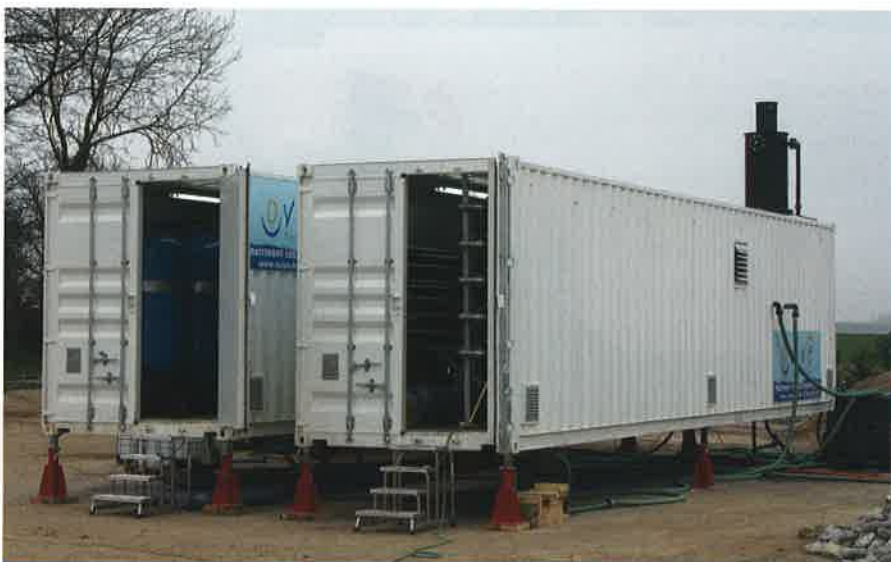
Station mobile de traitement par osmose inverse directe de Ovlive, avec un container filtration et un container de stockage de produits chimiques permettant une intervention en deux jours.
