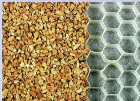
est pourvu d'un géotextile poreux côté inférieur. Le géotextile empêche le gravier de s'échapper sous les dalles et de s'infiltrer dans le sol ce qui aurait pour effet d'exercer sur celles-ci une poussée vers le haut au fil du temps. Le géotextile sert également de toile empêchant le passage des racines de plantes ».
