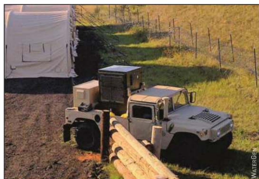
Figure 5. Dispositif de production d'eau par condensation installé sur un engin militaire tactique
