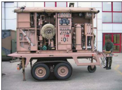
Figure 3. Dispositif mobile de production d'eau par distillation
