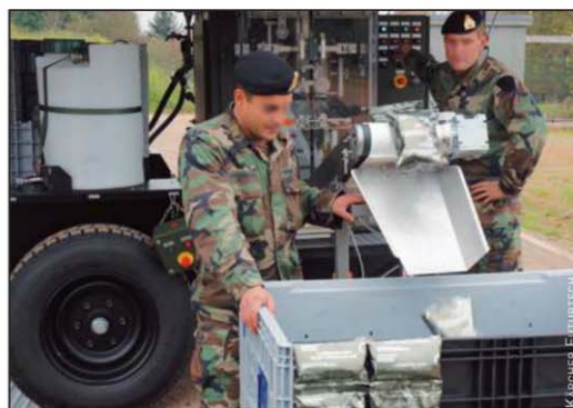
Figure 4. Dispositif mobile d'ensachage d'eau de boisson
