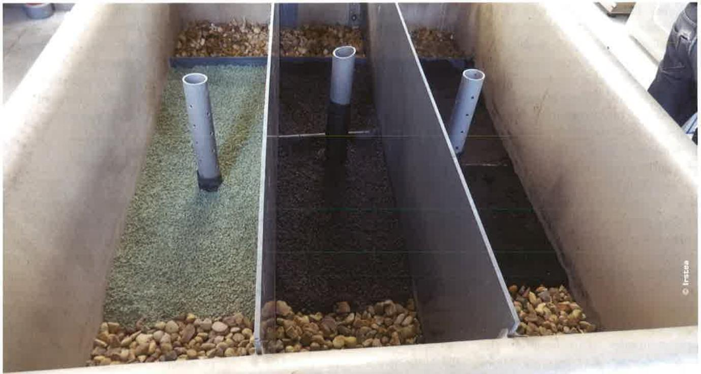
Pilote de traitement complémentaire des eaux usées avec 3 matériaux adsorbant testés (zéolite, argile expansée et charbon actif)
