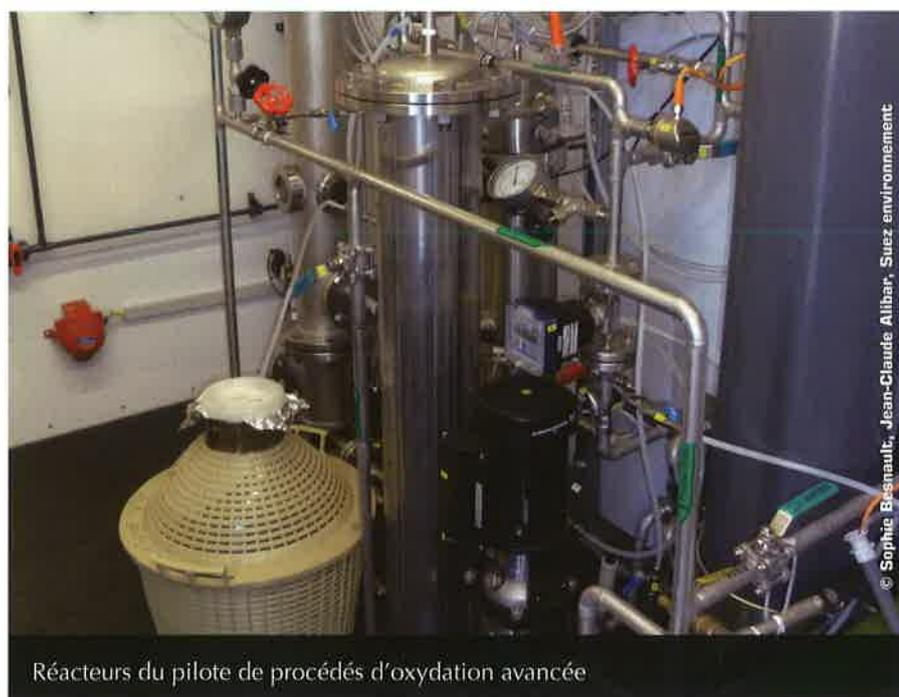
Réacteurs du pilote de procédés d'oxydation avancée
