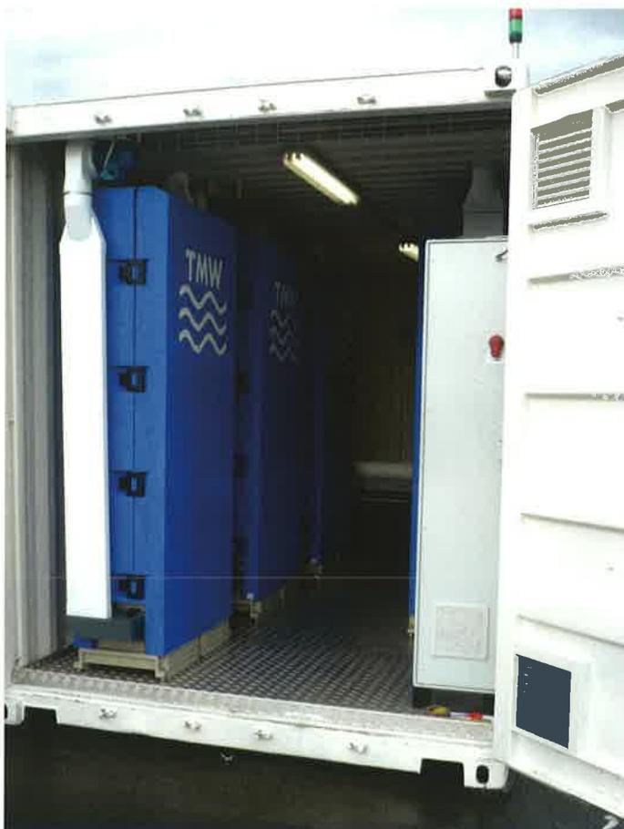
**TMW a développé la technologie d'évapo-concentration à pression atmosphérique et récupération d'énergie MHD qu'utilise l'Ecostill. Les industriels peuvent ainsi concentrer de 5 à plus de 10 fois leurs effluents. La réduction des volumes d'effluents à traiter entraîne une réduction équivalente des transports routiers et des pollutions qui en découlent.**
