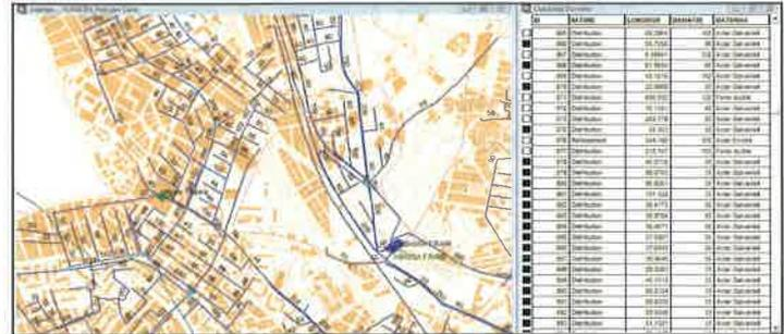
Figure 7. Résultat de requêtes affichant les canalisations avec un diamètre inférieur à 80 mm
