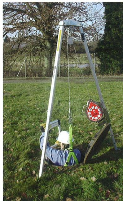
Trépied utilisé pour la descente en réseau.
