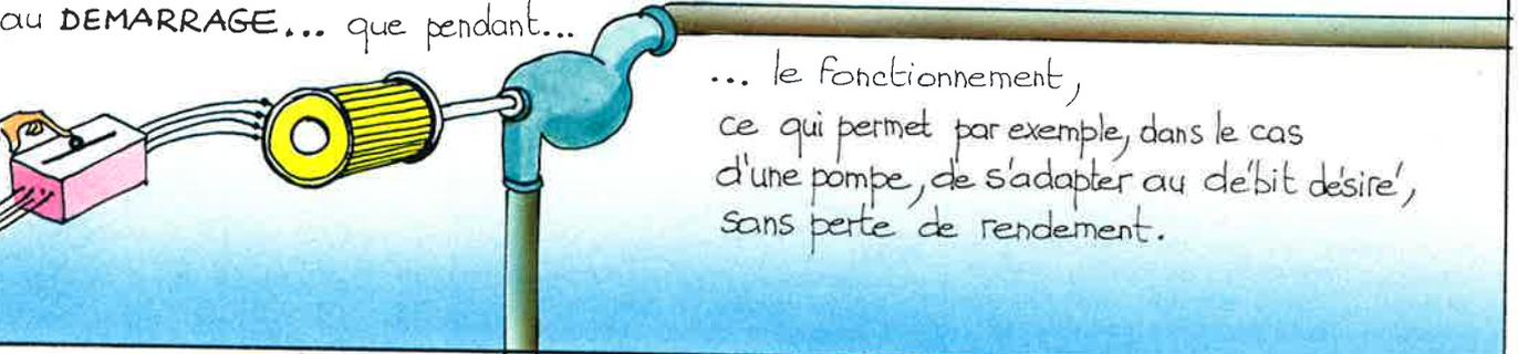
... le fonctionnement, ce qui permet par exemple, dans le cas d'une pompe, de s'adapter au débit désiré, sans perte de rendement.
