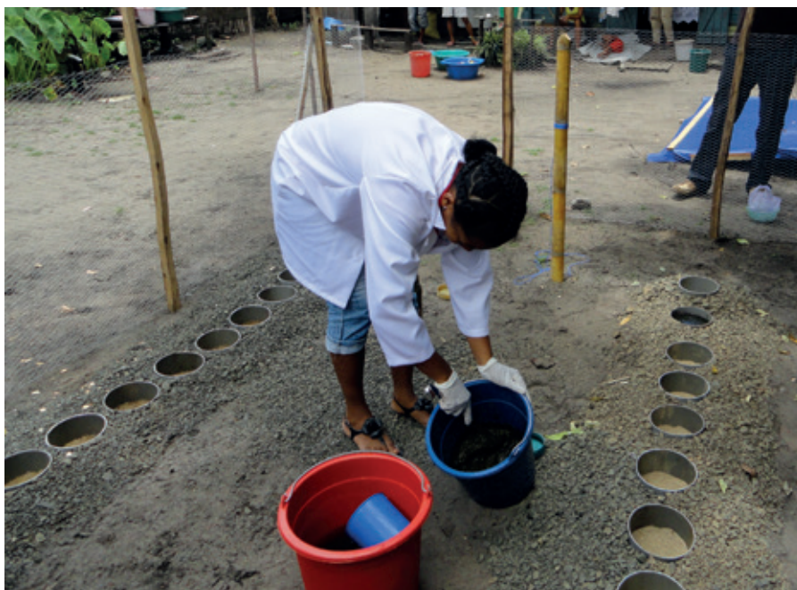
Test de séchage des boues.
