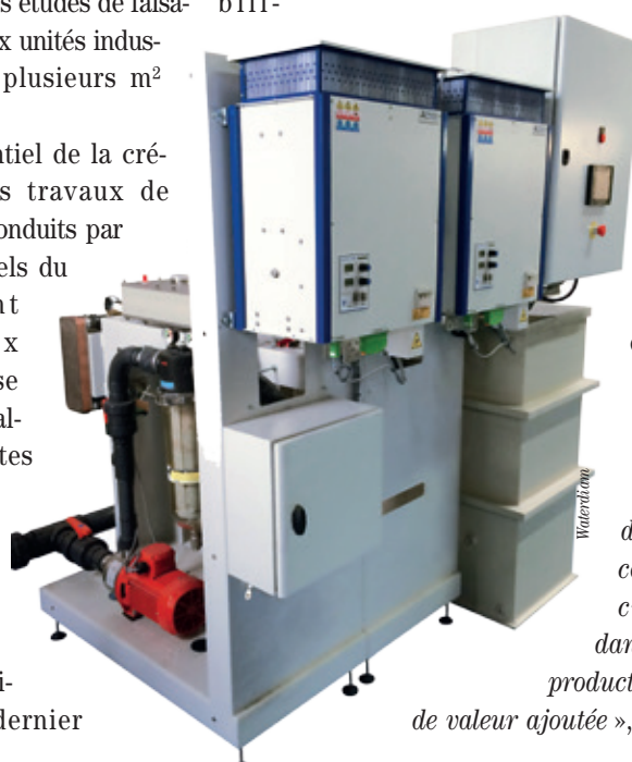
Vue d'une unité industrielle de traitement d'effluents industriels, procédé DiaClean® de Waterdiam (WWT 1 m 2 d'électrode BDD Diamant).
