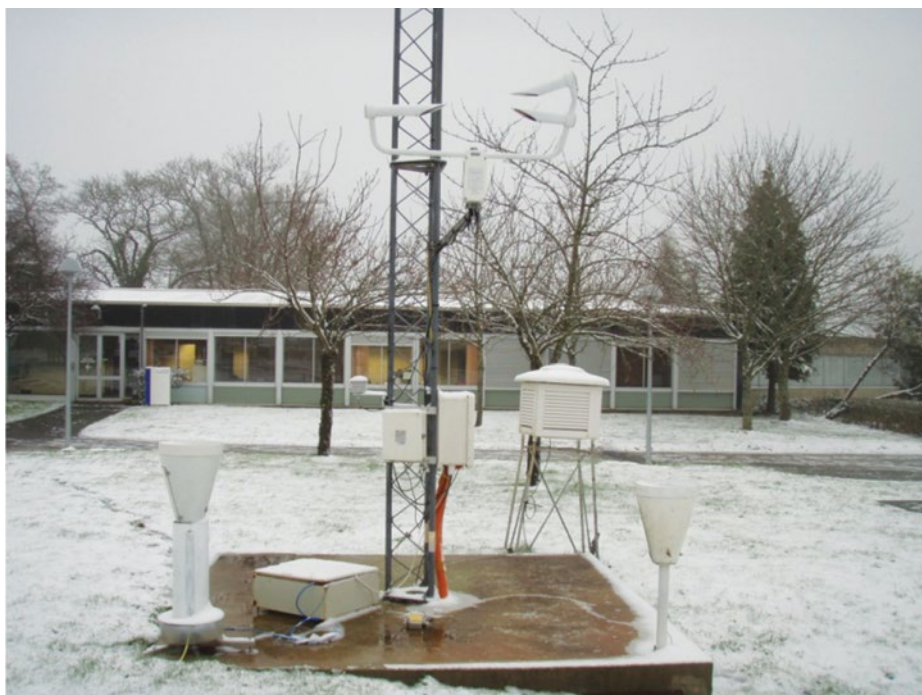
Figure n° 1 : La station météorologique du CSTB avec les capteurs pluviométriques testés.
