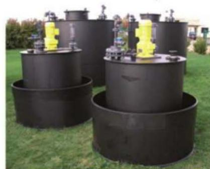
Désinfection des eaux usées par régulation de pH et chlore, par batch avec agitation
