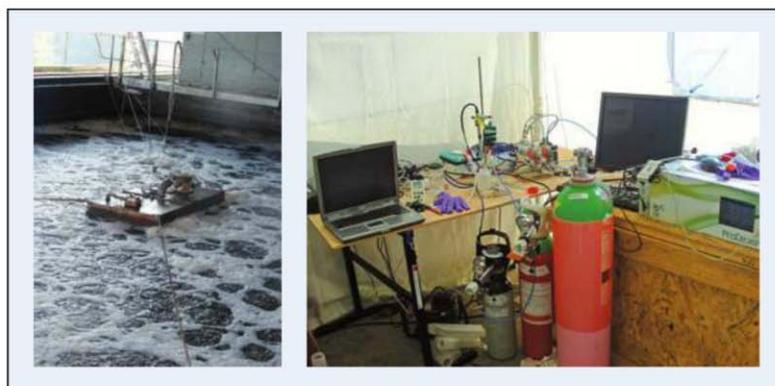
Figure 10. Cloche de prélèvement des émissions gazeuses au-dessus d'un biofiltre nitrifiant de la station SAV (gauche) et laboratoire de terrain permettant l'analyse du protoxyde d'azote (droite)
