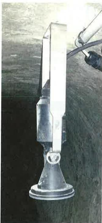
L'instrumentation des déversoirs se compose de sondes hauteur sur vitesse (sondes à ultrasons, sondes piézométriques, doppler).
