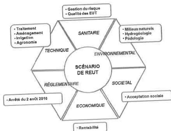
Fig. 5. Illustration de l'approche multithématique d'un projet de réutilisation des eaux usées traitées (REUT).
